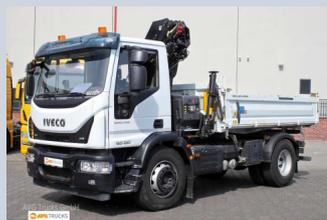
**Iveco ML180E 32 K benne basculante**
